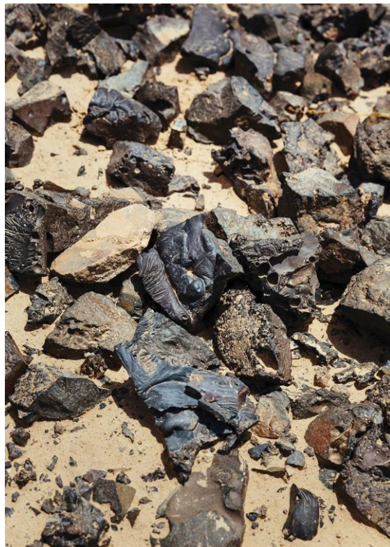
Scories noires, un sous-produit de la fusion du cuivre, qui sépare le métal précieux du minerai en fusion. Les scories jonchent encore les anciens sites de fusion. Yadid Levy
