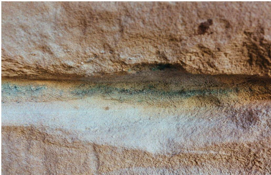
À Timna, les mineurs ont extrait le cuivre de veines vertes de malachite et de chalcocite. Les dépôts, dans le grès de toute la vallée et sous terre, sont encore visibles aujourd'hui. Yadid Levy
